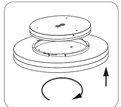
6. Leuchtenkörper auf die Bodenplatte drücken und drehen bis ein Klicken zu hören ist. Die Leuchte ist betriebsbereit.
