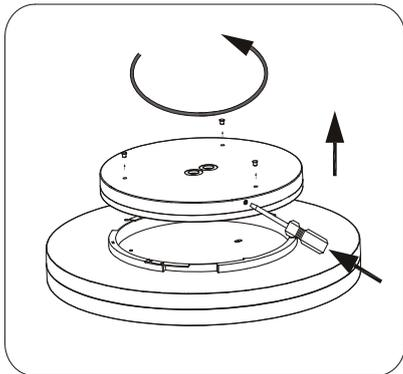
1. Arretierung mit einem Schraubenzieher eindrücken und Leuchte zum Öffnen drehen. Stecker zwischen Bodenplatte und Leuchtenkörper trennen, Fallsicherung öffnen.
