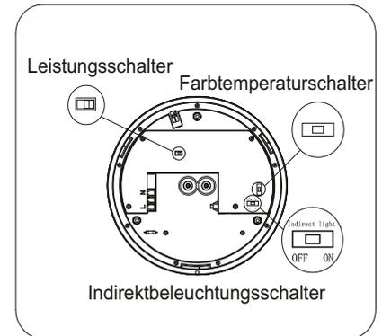
3. Gewünschte Leistung / Helligkeit und Farbtemperatur mittels Schiebeschalter einstellen. Bei Bedarf Indirektbeleuchtung einschalten.
