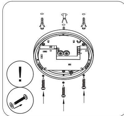
2. Bitte beachten! Nur mit montieren der mitgelieferten Kunststoffunterlegscheiben wird der IP54 Schutzgrad gewährleistet! Montagelöcher bohren und Montageplatte befestigen.
