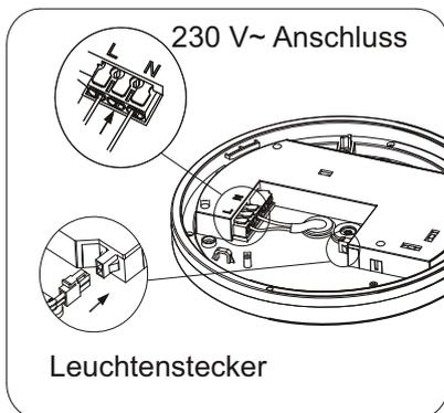
4. Zuleitung an der Klemme anschließen. Fallsicherung befestigen und Leuchtenstecker verbinden.
